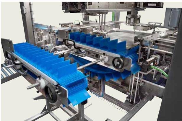
Aplicaciones especiales para encajado de productos en vertical, lateralmente, encajado mediante succión por vacío, etc. Disponen de varias tecnologías para adaptarse perfectamente a su producto.
