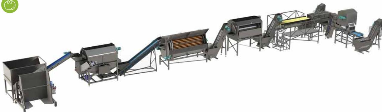
Marcelissen dispone de líneas completas para el procesamiento de tubérculos abarcando desde la recepción del producto, alimentación, limpieza, quitapiedras, sinfines, maquinaria para el pelado, inspecciones, cortes, rodillos, cribas, y escurrido.
